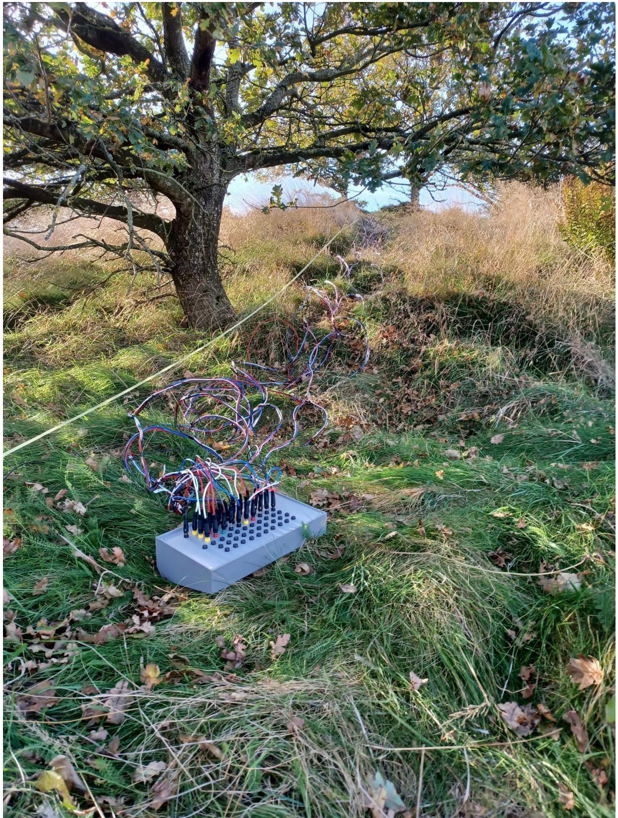
Figur 3. Opstilling i felten. Hvert kabel går til et målepunkt tværs over højen med en meters afstand. Samleboksen forbinder ledningerne med selve måleapparatet, der dog ikke ses her. Målebåndet viser det omtrentlige forløb af hovedlinjen, der løb lige vest for egetræet. Set mod syd.
